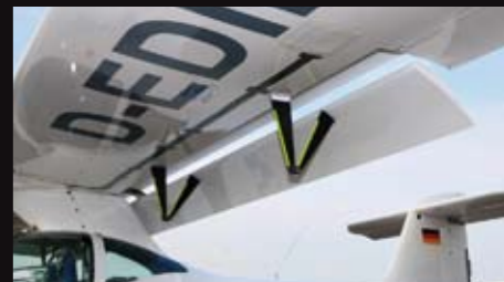
STOL-ELEMENTE: Die große einteilige Fowler-Klappe und ein Wasserwirbel erzeugendes Zackenband am hinteren Ende des Bootskörpers sorgen für kurze Startlaufstrecken.
